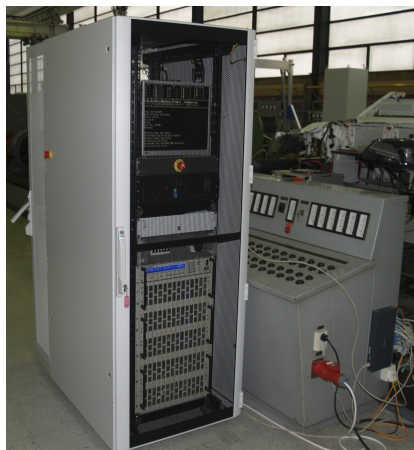
Batteriesimulator bestehend aus der Echtzeiteinheit und den elektronischen Quellen/Senken NL1V20C340 (20V/ \pm 340A).
