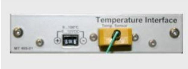
Mit der Temperatur-Messumformerkarte werden über einen NiCr-Ni (Typ K) Fühler Temperaturen von 0...100°C erfasst und in eine Analogspannung 0...10VDC umgewandelt. Diese Analogspannung kann an den analogen Steuerkanal der Analog I/O Schnittstelle geführt und über eine Datenschnittstelle ausgelesen werden.
