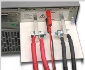
**Kabel an die Lasteingänge und an die Senseeingänge anschließen**
