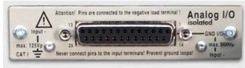
Bei Potentialunterschieden zwischen dem negativen Lasteingang und dem "GND" der Analog I/O Schnittstelle sollte die Anlogschnittstelle gegen eine voll isolierte Version (Option ZS06) getauscht werden. Die beiden Karten sind pinkompatibel. Die Isolationsspannung der Option ZS06 beträgt 500VDC. Bitte beachten Sie dazu auch Kapitel 6.5
